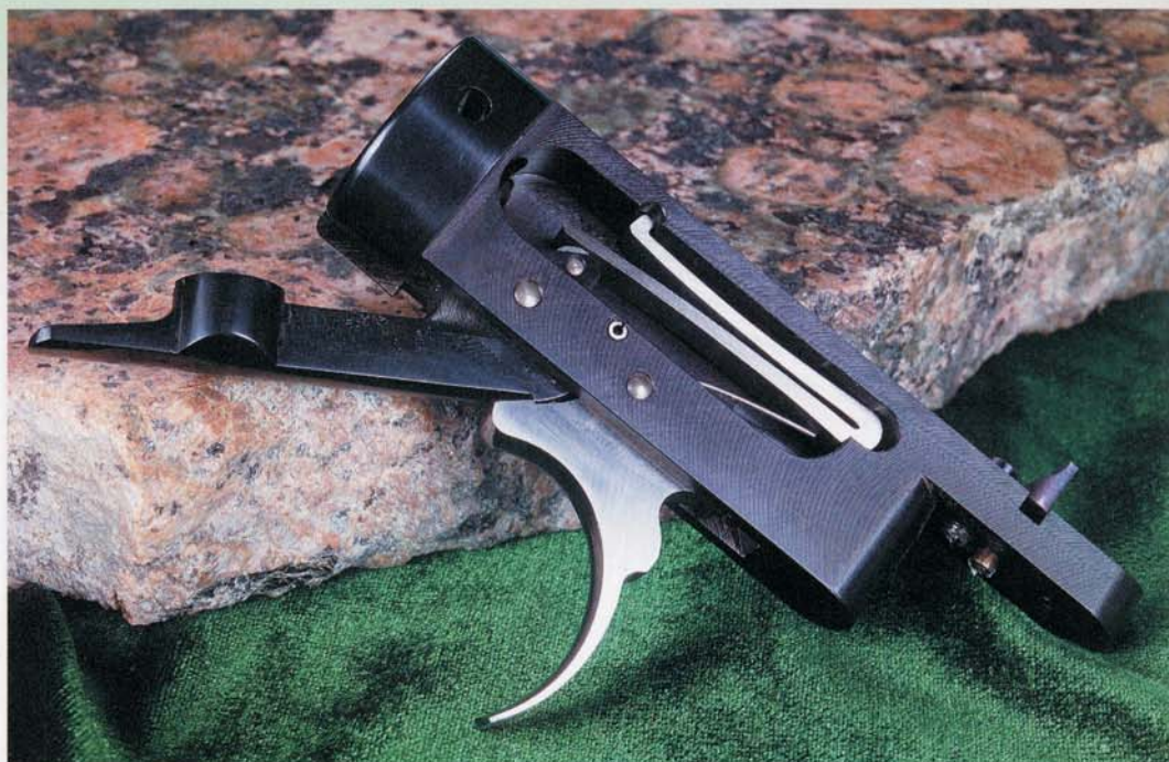
Inneneinrichtung: Das Systemgehäuse enthält bloß vier genial simple Schloßteile. Von unten vorn wirkt der mit einem Röllchen bestückte Hahn-Kopf auf die Spitze des Schlagfederschenkels. Der dünne Draht ist am Abzug angeschraubt und löst beim Abziehen die Spannung der Feder.
