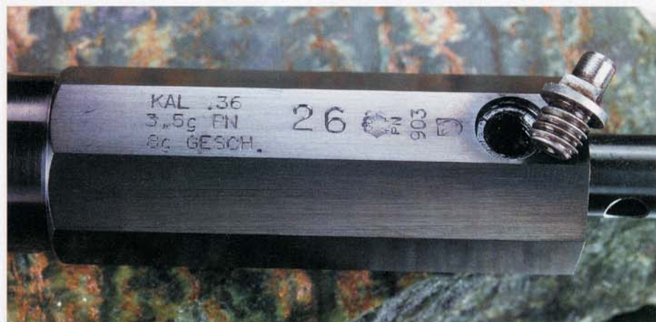
Anleitung: In sauberer Schrift finden sich an der Laufunterseite eingraviert die Hersteller-Ladeempfehlungen. Das Edelstahl-Piston ist perfekt gearbeitet; es läßt sich leicht ein- und ausdrehen. Der passende Schlüssel liegt jeder Waffe bei.
